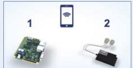
Die Übermittlung von Messwerten, Positionsdaten, Fehlerberichten und anderen nützlichen Daten des Aufzugs in die Cloud erfordert ein Minimum an technischer Ausrüstung. Neben unserem Controller, der alle Messwerte und Daten sammelt, ist ein Gateway notwendig, um die Informationen in ein cloud-kompatibles Format umzuwandeln. Eine zweite, sehr wichtige Funktion des Gateways besteht darin, den Controller über eine sichere Verbindung mit dem Internet zu verbinden.
